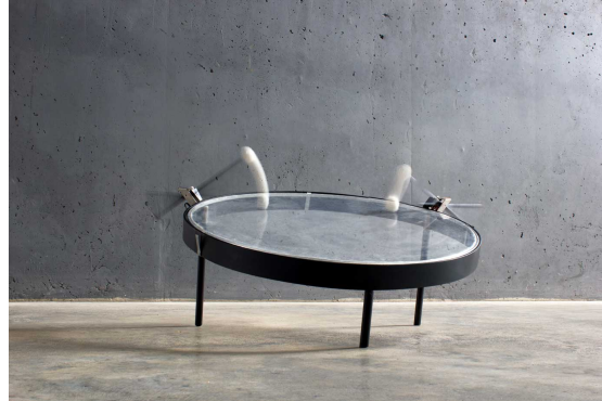
Figura 26: Le rilevazioni controllano tramite un solenoide motorizzato le bacchette, al crescere della rilevazione aumenterà la velocità e il rumore del tamburo 35
